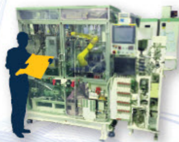
ロボット搬送 ボルト組付 出荷検査装置
